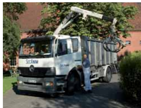
Véhicule de collecte des animaux trouvés morts en élevage SecAnim équipé d'un bras de chargement
